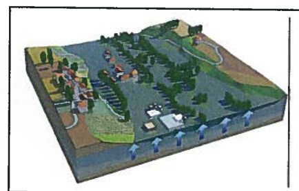
inondation de nappe
