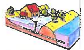
Par remontée dans les réseaux d'assainissement dans des points bas localisés
