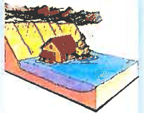
Par accumulation d'eau ruisselée
