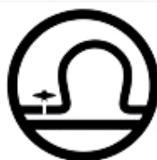
conduites fixes de matières dangereuses
