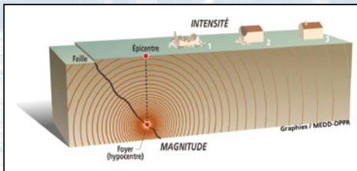
Le foyer est le point de départ de la rupture des roches.
