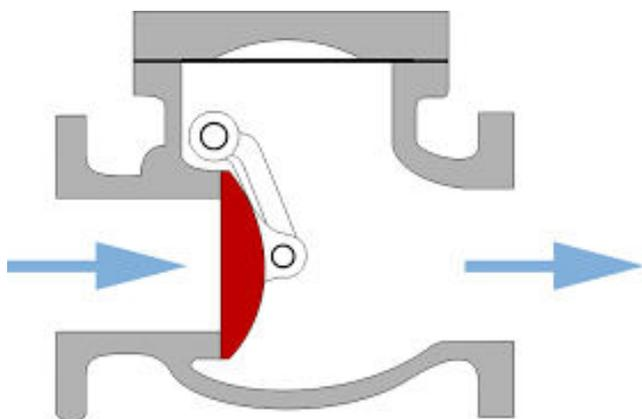
*Schéma d'un clapet anti-retour à battant, dispositif qui ne laisse circuler l'eau que dans un sens dans un tuyau.*
