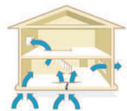
Drainage du radon par mise en dépression du sol sous-jacent au bâtiment.
