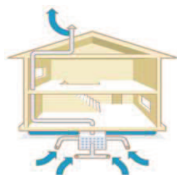
Drainage du radon par mise en dépression du sol sous-jacent au bâtiment.
