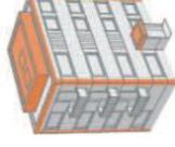
**Vérifier les ancrages.** Vérifier les ancrages des parties du bâtiment exposées au vent, des angles, auvents, cheminées, antennes et panneaux publicitaires.
