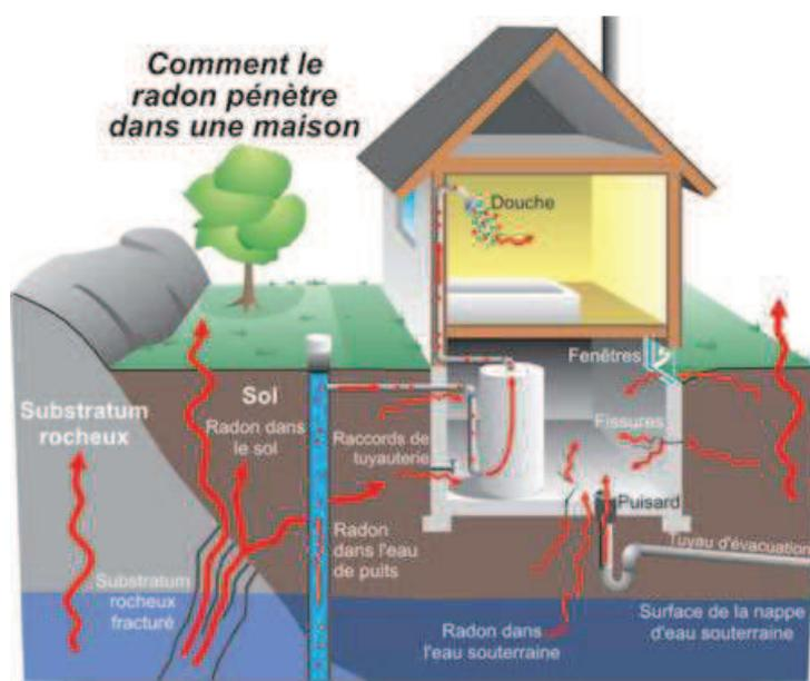
C'est principalement par le sol que le radon transite et se répand dans l'air intérieur des bâtiments. L'importance de l'entrée du radon dans un bâtiment dépend :
