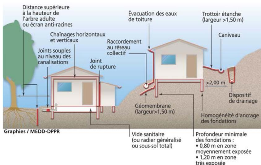
Des précautions élémentaires, tant dans le cas de constructions existantes que de constructions neuves, permettent de réduire le risque. Parmi celles-ci, la vérification de l'étanchéité des canalisations enterrées, l'adaptation des réseaux de drainage et de rejets d'eaux pluviales, ainsi que l'élagage régulier voire l'élimination de certaines espèces de végétaux qui assèchent le sol en profondeur, suffiraient dans bien des cas, à prévenir le risque de retrait-gonflement des argiles.
