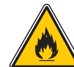
Matières inflammables ou haute température
