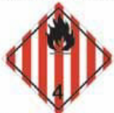
N°4.1 Danger de feu (matière solide inflammable)
