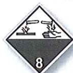
N°8 Matière corrosive
