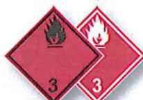
N°3 Danger de feu (matière liquide inflammable)
