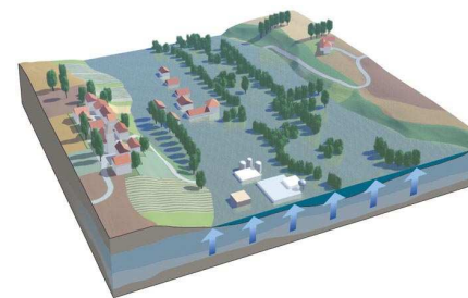
inondation de nappe
