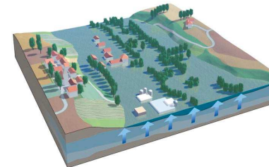
inondation de nappe
