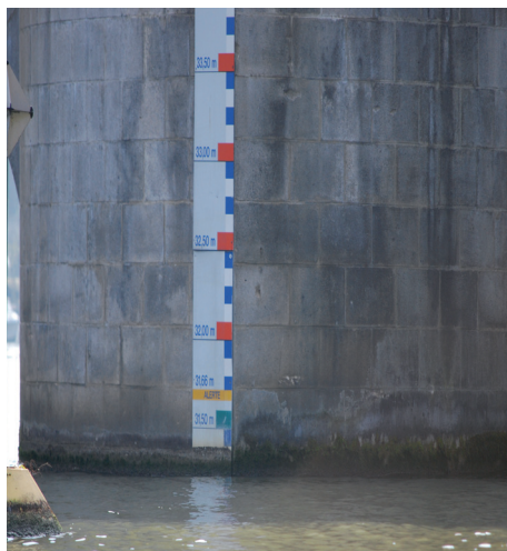
Des échelles d'indication de niveau de l'eau sont visibles Pont Solférino et Pont de Soissons. Le niveau jaune représente le seuil d'alerte.
