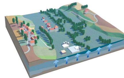
inondation de nappe
