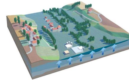
inondation de nappe
