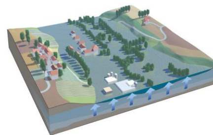
inondation de nappe
