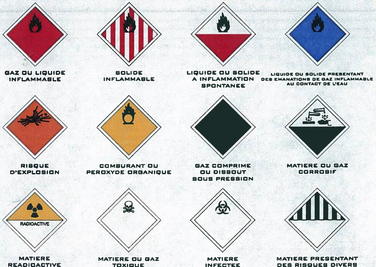
Fig. n° 11: La signalisation des véhicules
