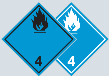
Danger d'émanation de gaz inflammable au contact de l'eau
