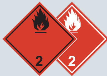
Danger de feu (liquide ou gaz)
