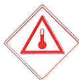
Marque pour les matières transportées à chaud
