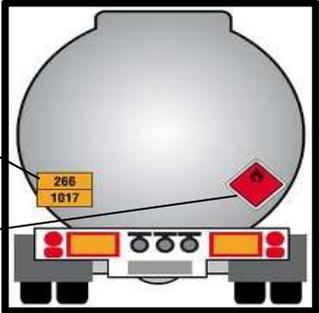
Le symbole de danger: c'est un pictogramme qui symbolise la nature du risque présenté par la matière transportée. Il est représenté sur des "plaques étiquettes" carrées de 30 cm x 30 cm "pointes en bas" placées à l'arrière du véhicule et sur les côtés:
