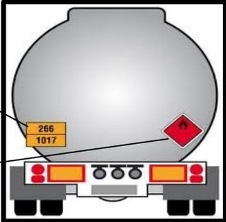
Le symbole de danger: c'est un pictogramme qui symbolise la nature du risque présenté par la matière transportée. Il est représenté sur des "plaques étiquettes" carrées de 30 cm x 30 cm "pointées en bas" placées à l'arrière du véhicule et sur les côtés:
